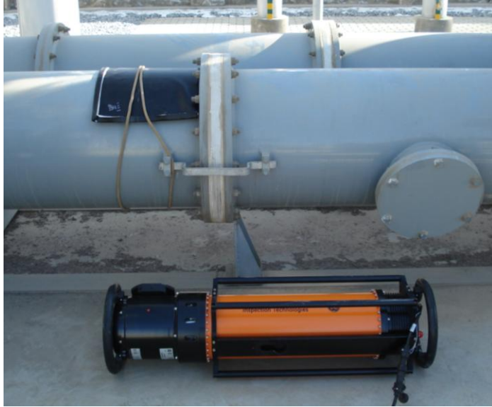
图 7 射线机、成像板摆放位置
