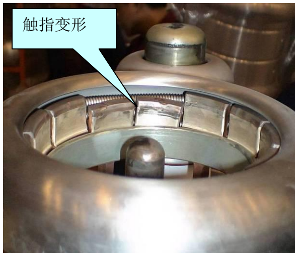
静触头触指变形
