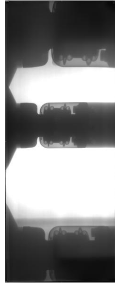
图 8 母线连接影像
