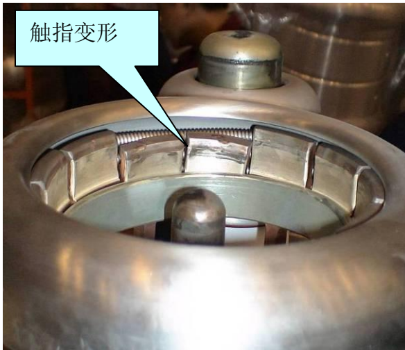
静触头触指变形
