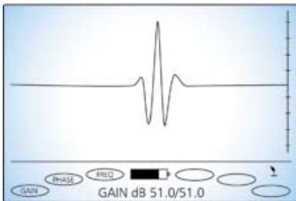
时基模式下的螺栓孔检测结果
