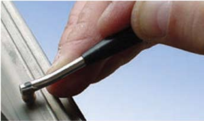
使用绝对式铅笔探头进行表面检测
