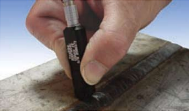
运用特别设计的Weldscan探头进行焊缝检测
