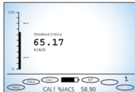
非铁磁性材料的电导率检测
